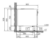
ΕI Electrical inlet (power) Equipotential screw EQ
